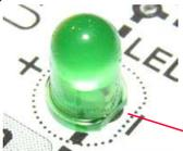
Hier befindet sich die abgeflachte Stelle am LED-Gehäuse.
